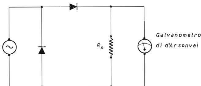
Fig. 2.2.9.2 Schema più particolareggiato dello strumento raddrizzatore.
