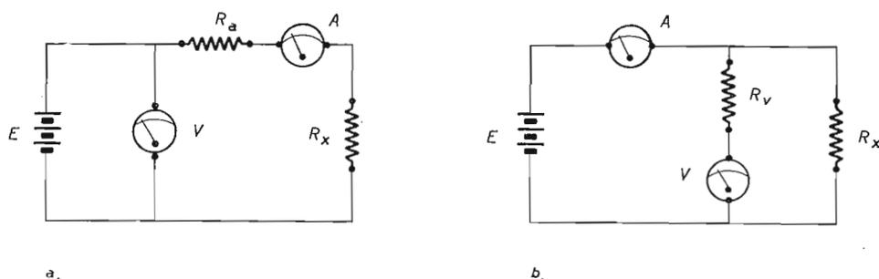
Fig. 4.1.1.1 Un semplice metodo di misura delle resistenze.
