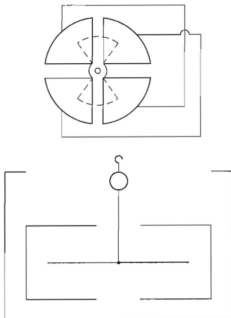
*Fig. 2.3.1.3 Meccanismo di funzionamento di un elettrometro a quadranti.*
