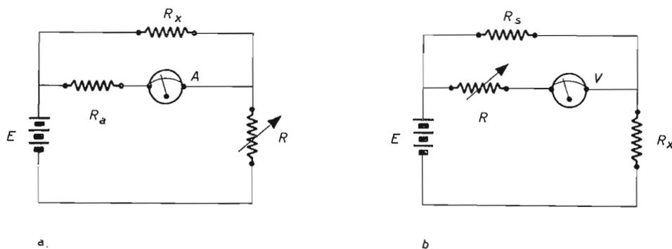
Fig. 4.1.2.2 Schemi di principio di due possibili ohmetri.
