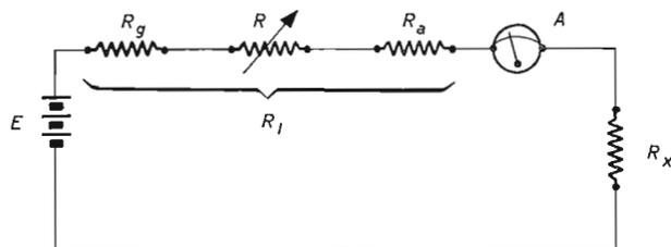
Fig. 4.1.2.1 Schema di principio di un ohmetro.
