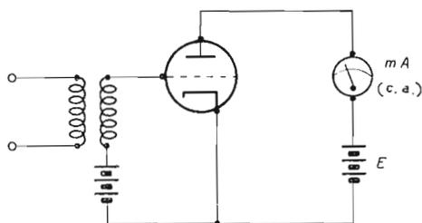
Fig. 5.2.1.2 Circuito per la misura diretta della trasconduttanza.
