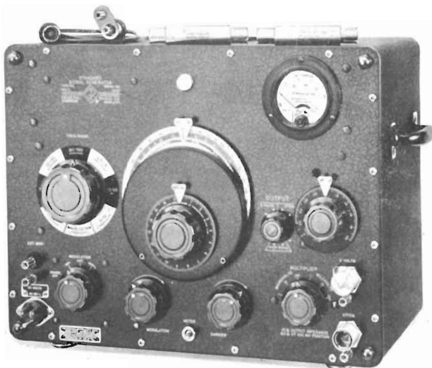
*Fig. 7.4.2 Generatore di segnali campione General Radio 1001 A.*
