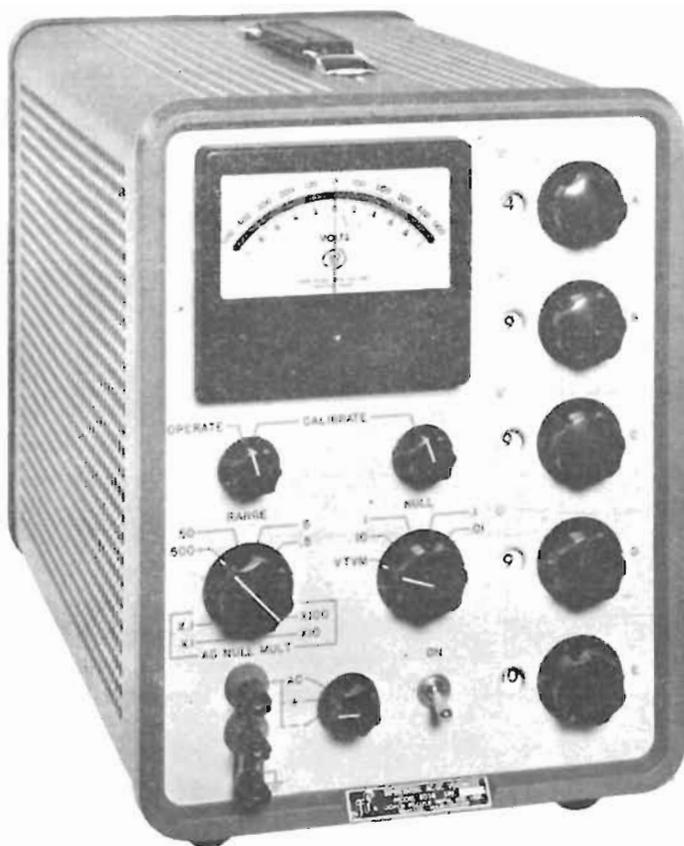
Fig. 2.3.5.2 Il voltmetro differenziale John Fluke Mod. 803 B.
