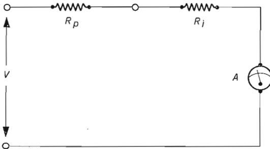
*Fig. 2.3.2.1 Milliamperometro modificato per essere usato come voltmetro.  $R_i$  è la resistenza interna dello strumento,  $R_p$  la resistenza addizionale, A è un galvanometro di d'A.*
