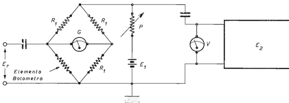
Fig. 2.4.6.1 Disposizione degli strumenti per una misura bolometrica di potenza a radiofrequenza.
