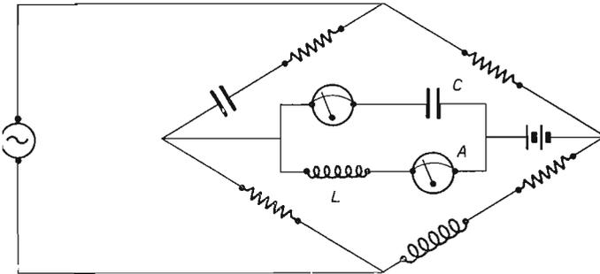
Fig. 4.2.2.3 Ponte per misure di induttanza incrementale.
