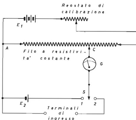
Fig. 2.3.3.1 Circuito elementare di un potenziometro.
