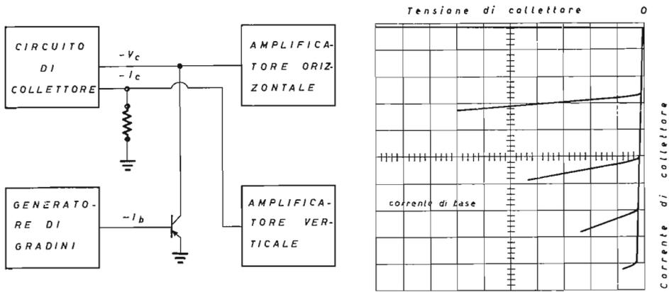
Fig. 5.5.5 Connessione dei blocchi funzionali del pannello dello strumento di figura 5.5.1 per il tracciamento delle caratteristiche di collettore di un transistor  $p-n-p$  nella configurazione con emettitore comune.
