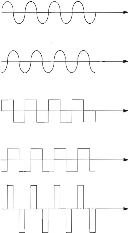
*Fig. 6.3.3.1 Metodo delle onde quadre per la misura dello sfasamento.*
