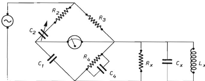
Fig. 4.5.4 Schema di principio del ponte Boonton 250 A.
