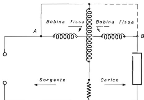
Fig. 2.4.2.1 Schema elementare di funzionamento di un wattmetro elettrodinamico.
