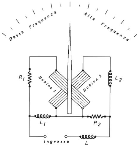
Fig. 6.1.2.1 Schema di un frequenzimetro Weston.
