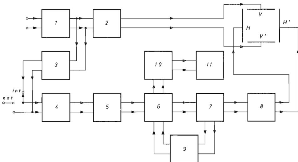
Fig. 3.2.3.1 Schema a blocchi di un oscilloscopio.
