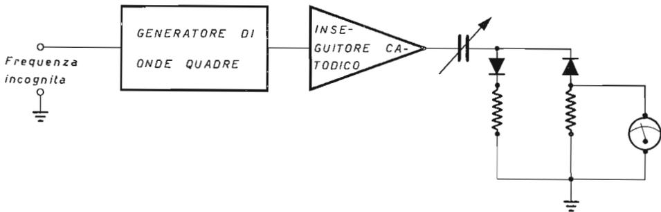
Fig. 6.1.5.1 Schema di principio di un frequenzimetro elettronico.
