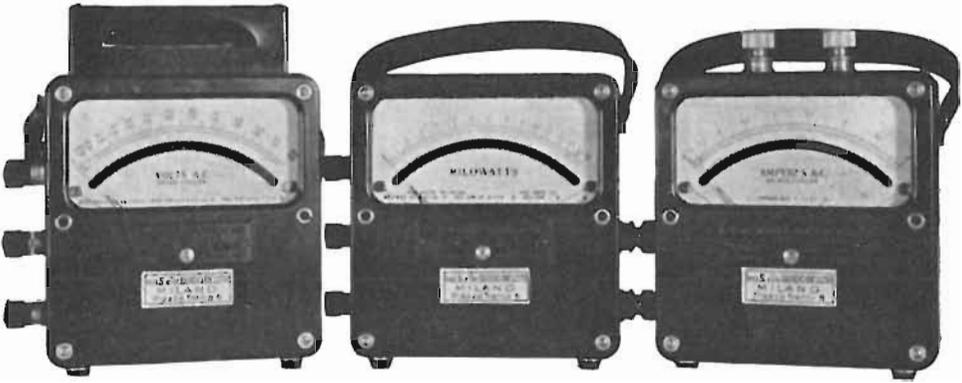
Fig. 2.2.6.2 Un voltmetro a ferro mobile, un wattmetro di tipo elettrodinamico (fr. 24.2) ed un amperometro a ferro mobile. Tutti questi strumenti sono fabbricati dalla Weston Electrical Instrument Corp.
