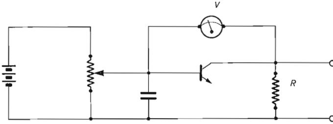
Fig. 5.3.2.3 Circuito per la misura di  $C_e$ .
