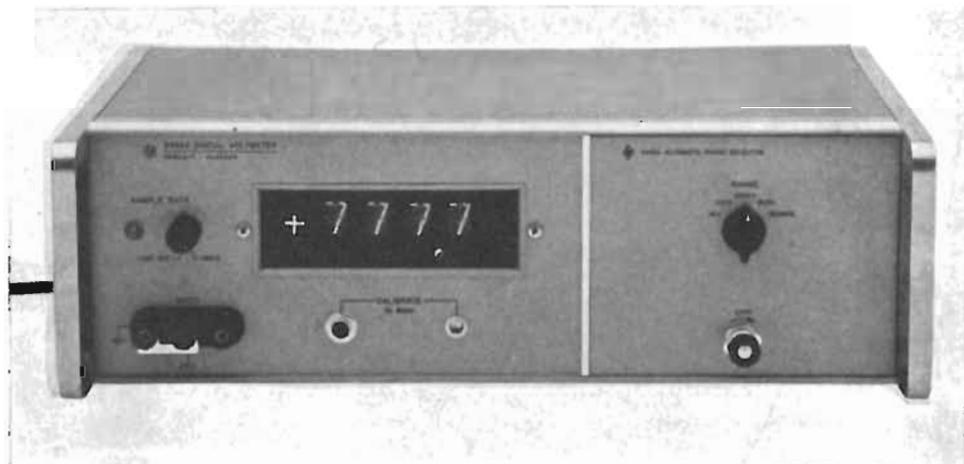
Fig. 2.3.6.2 Il voltmetro numerico Hewlett-Packard Mod. 3440 A.
