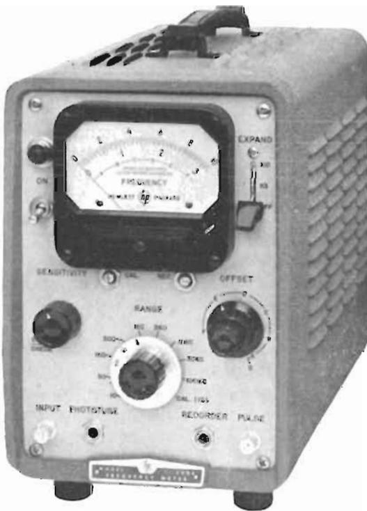
*Fig. 6.6.1 Frequenzimetro elettronico Hewlett-Packard 500 B.*
