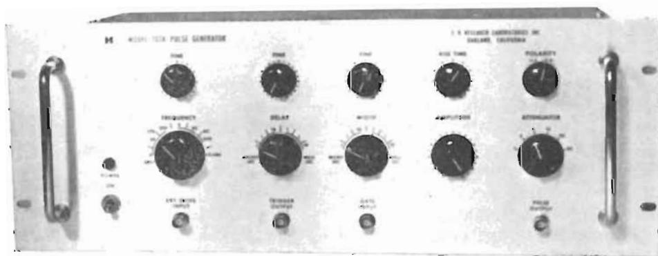
*Fig. 7.4.3. Generatore di impulsi EH 132 A.*
