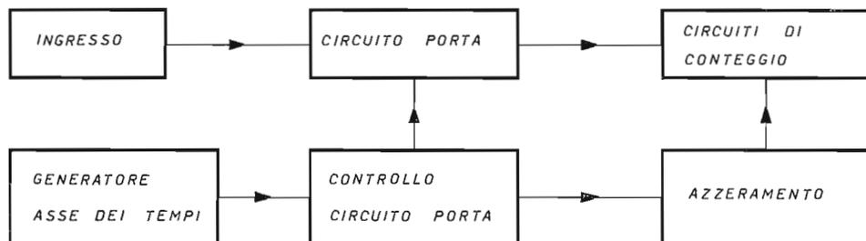
Fig. 6.1.6.1 Schema di principio di un contatore elettronico.
