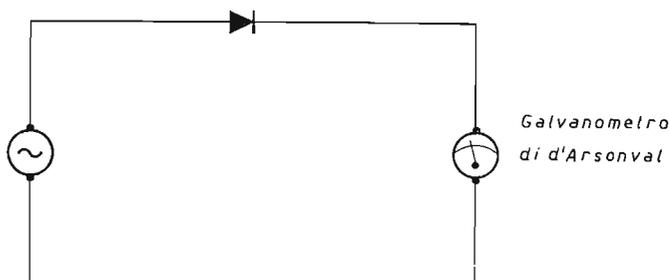
Fig. 2.2.9.1 Schema di principio semplificato di uno strumento rettificatore per la misura di correnti alternate.
