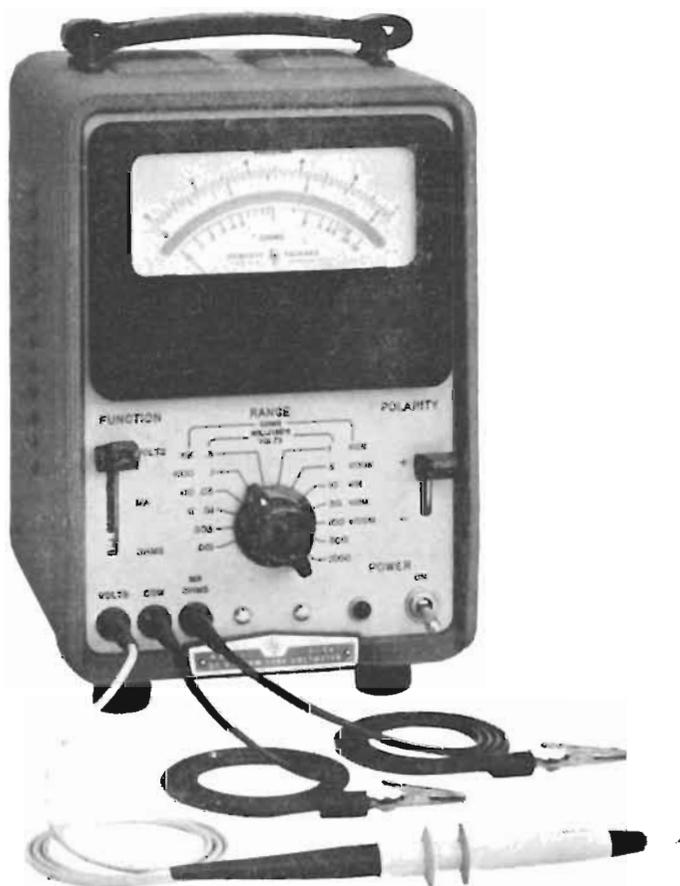
Fig. 2.6.2 Il VTVM Hewlett-Packard Mod. 412 A.
