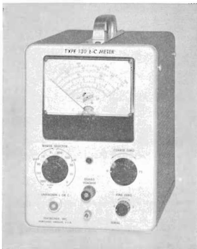
Fig. 4.5.6 Misuratore di piccole capacità e induttanze Tektronix 130.
