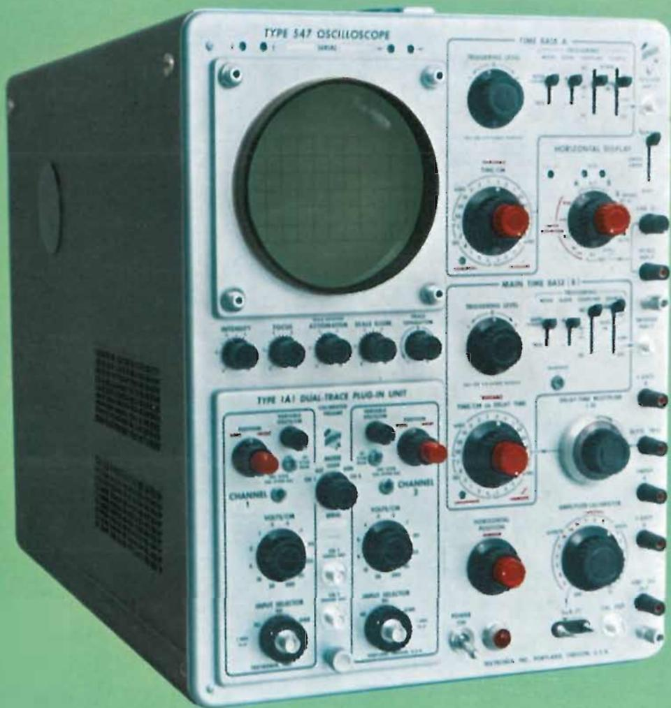
*Fig. 3.4.3. L'oscilloscopio Tektronix Mod. 547 col Plug-In Mod. 1A1.*
