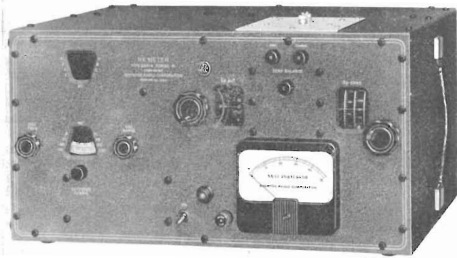
Fig. 4.5.3 Ponte Boonton 250 A per misura di impedenze complesse.
