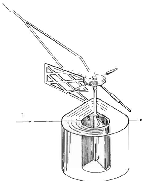
*Fig. 2.2.6.1 Meccanismo di funzionamento di un amperometro a ferro mobile.*
