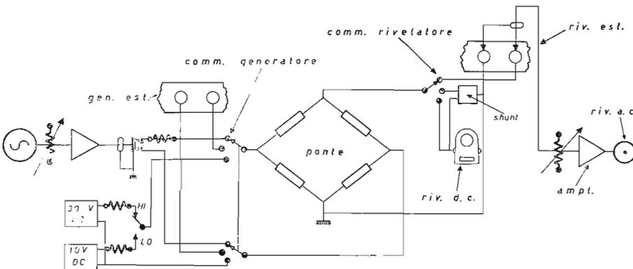
Fig. 4.5.2 Schema di principio del ponte ESI 250 DA.
