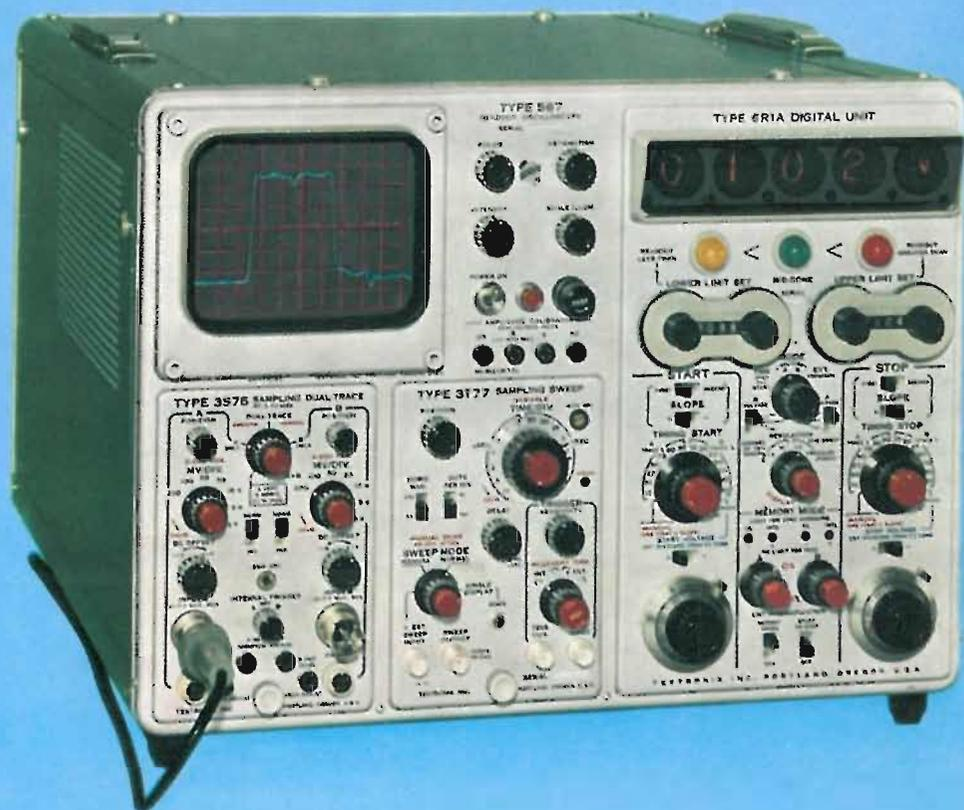
Fig. 3.2.5.1 L'oscilloscopio campionario Tektronix Mod. 567 con lettura numerica delle caratteristiche del segnale. Questo oscilloscopio ha un tempo di salita di 0.4 ns ed una sensibilità di 2 mV/div.
