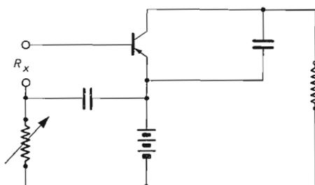
Fig. 5.3.2.2 Circuito per la misura di  $r_b$ .
