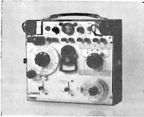
Fig. 4.5.1 Ponte ESI 250 DA per misura di resistenze, capacità e induttanze.
