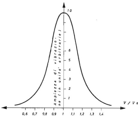
Fig. 2.2.4.1 Curva di risonanza di un galvanometro a vibrazione.
