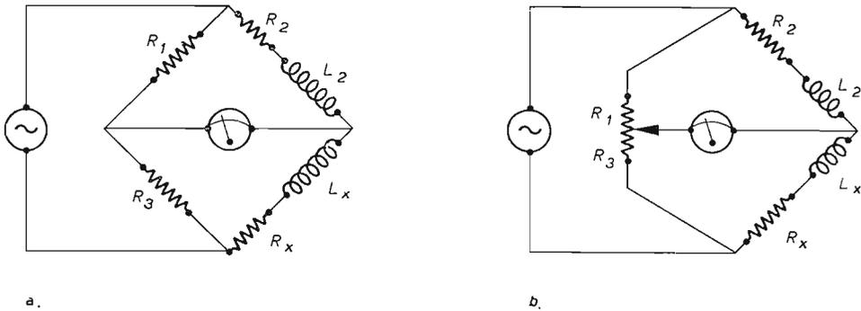
Fig. 4.2.2.1 Ponte di Maxwell-Wien per misure di induttanza.
