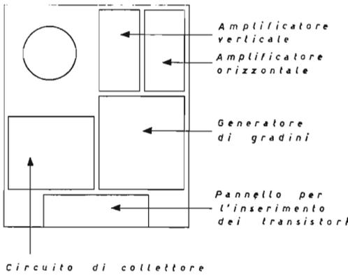
Fig. 5.5.3 Blocchi funzionali del pannello dello strumento di figura 5.5.1.
