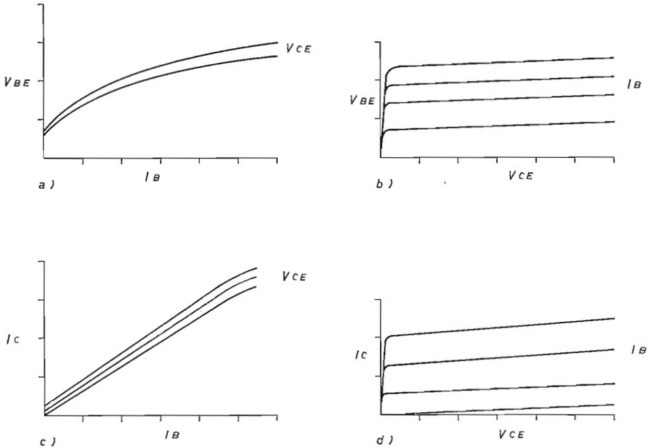
Fig. 5.3.1.2 Caratteristiche di un transistoro nella configurazione con emettitore comune: a. caratteristiche di ingresso; b. caratteristiche di trasferimento inverso; c. caratteristiche di trasferimento; d. caratteristiche di uscita.
