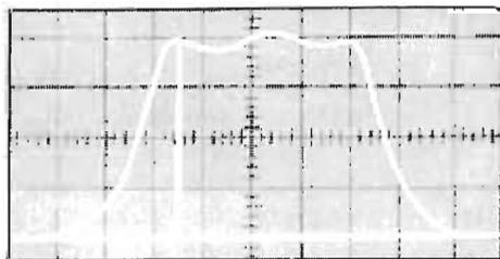
*Fig. 7.1.2.1 Esempio di curva di risposta in frequenza tracciata per mezzo di un generatore a spazzolamento. È visibile anche il marker.*
