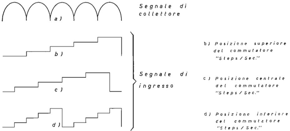
Fig. 5.5.2 Forme d'onda fornite dallo strumento di figura 5.5.1.
